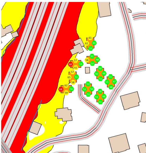
Figur 7 Støyforhold før skjermingstiltak. Illustrasjon: Rambøll.
